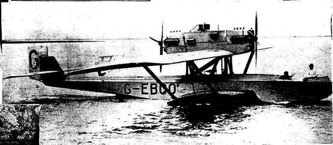
INGLATERRA.—El gigantesco monoplano Dornier-Wal, con motores Napier montados en tandem, que está utilizando el Cap. Courtney en su vuelo desde Londres a New York, con escala en las Azores.
